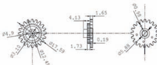
SEP-R10 (20 denti esterni - 30 interni / 20 external teeth - 30 internal) Trattori Marine VDO/Marine VDO tractors
